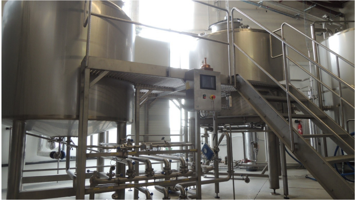
Salle de brassage vue cuve filtre avec porte de sortie de la drêche :
