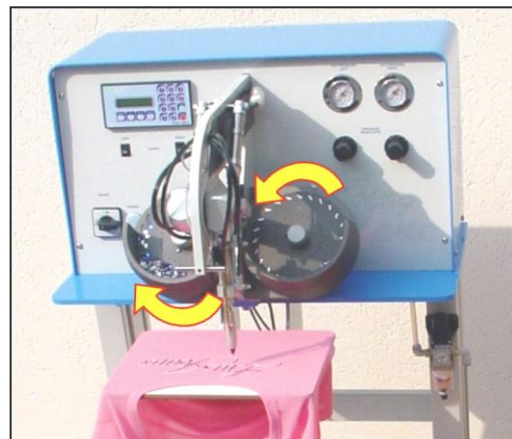
Fig. 7.2 : Senso di rotazione per il caricamento strass/borchie
