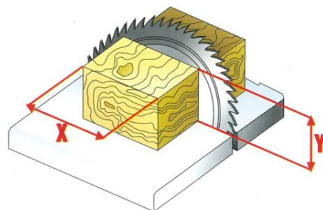
Capacità di taglio con lama ø 500 mm.
