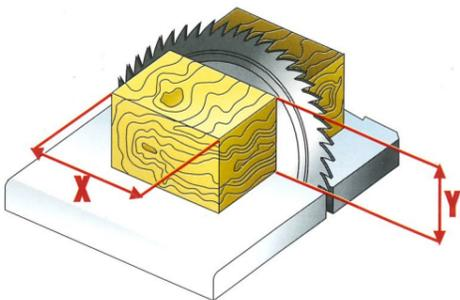
Capacità di taglio con lama  $\varnothing$  450 mm.
