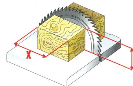
Capacità di taglio con lama  $\varnothing$  350 mm.
