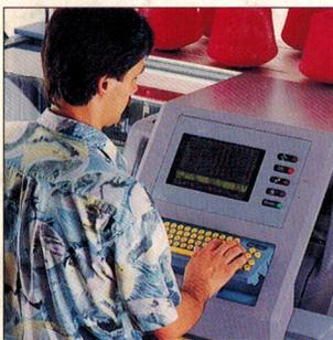
Vollständige Programmübersicht am Display und direkter Zugriff auf alle Strickanweisungen. Ergonomische, verschiebbare Eingabeeinheit. Einfache Klartexteingabe der SINTRAL-Anweisungen durch vollständiges, alphanumerisches Tastenfeld.
