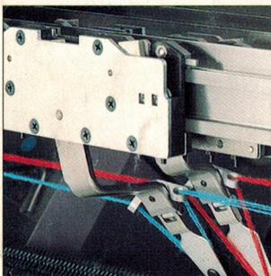
Serienmäßig ist jede CMS eine Intarsienmaschine. Bis zu 32 Intarsienfarben in jeder Strickreihe durch einfaches Aufschieben der Intarsienfadenführer, kein Maschinenumbau erforderlich. Vielfältige Intarsien-Kombinationsmuster einschließlich Splitten. Automatische Positionierung der Fadenführer am Anfang und bei Größenwechsel.
