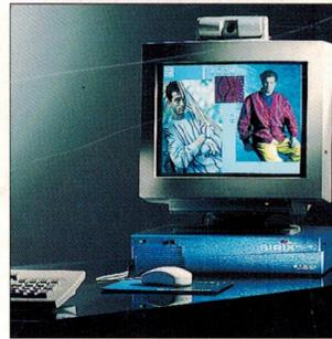
SIRIX-Musteranlagen in abgestufter Leistung unterstützen den Musterentwurf und die Strickprogrammerstellung. In Verbindung mit SELAN online Daten- und Musteraustausch zwischen Strickmaschinen und SIRIX. Online Produktionsüberwachung, automatischer Report mit Laufzeit, Start- und Endzeitangabe jedes einzelnen Strickauftrages.
