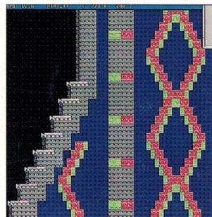
Vereinfachung des Strickentwurfs mit der anwendungsfreundlichen SIRIX Oberfläche. Erstellung von Fully-Fashion-Programmen auf Grafikbasis durch Mustermodule und Überlagerung von Schnitten. SIRIX AUTOSINTRAL erzeugt automatisch das Strickprogramm aus dem Jacquard. Modelle können schon vor dem Stricken begutachtet werden.
