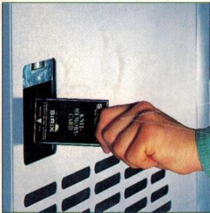
Blitzschnelle und flexible Programmierung der CMS 440.6 durch die Knit-Memory-Card oder online über das Netzwerk SELAN. Die Multiprozessorsteuerung setzt die SINTRAL-Strickbefehle in Maschinensteuerfunktionen um und optimiert automatisch die Strickleistung. Automatischer Test der Strickprogramme.
