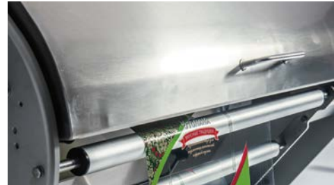
Solidité maximale et sécurité grâce aux carters arrondis en acier inox.
