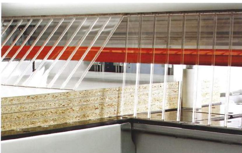
L'alignement latéral se fait par un rouleau de caoutchouc avec prépositionnement motorisé faisant en sorte que le matériau reste contre l'équerre, pour permettre l'équarrissage des pièces coupées. L'action du dispositif d'alignement latéral est intégrée automatiquement dans les cycles de travail de la machine.
