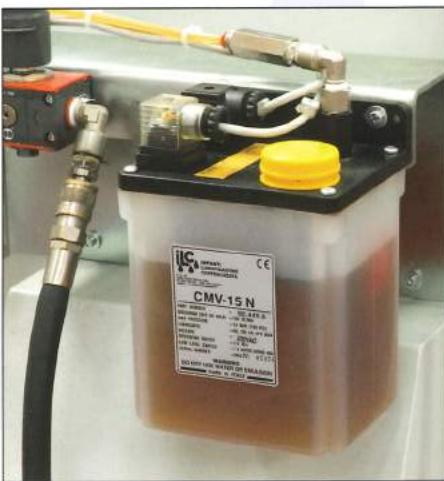
Lubrificazione automatica centralizzata gestita da CN su tutti i movimenti della macchina.
