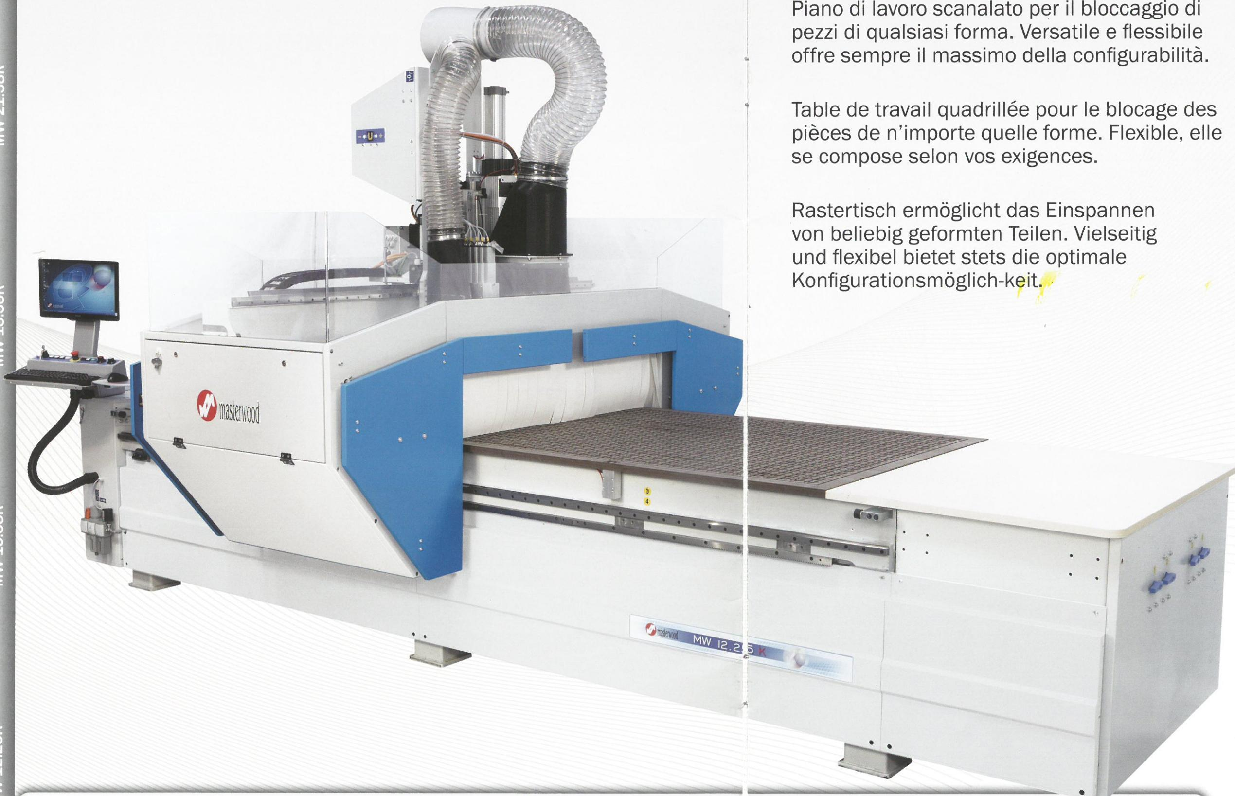
Il centro di lavoro a controllo numerico con piano scanalato per la lavorazione di nesting ad elevata produttività.
