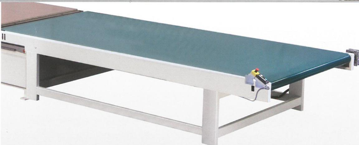
Sistema di scarico con tappeto motorizzato. Consente, in abbinamento al dispositivo di ausilio allo scarico, di estrarre in modo automatico i componenti lavorati sulla macchina e di presentarli all'operatore che manualmente li deposita.
