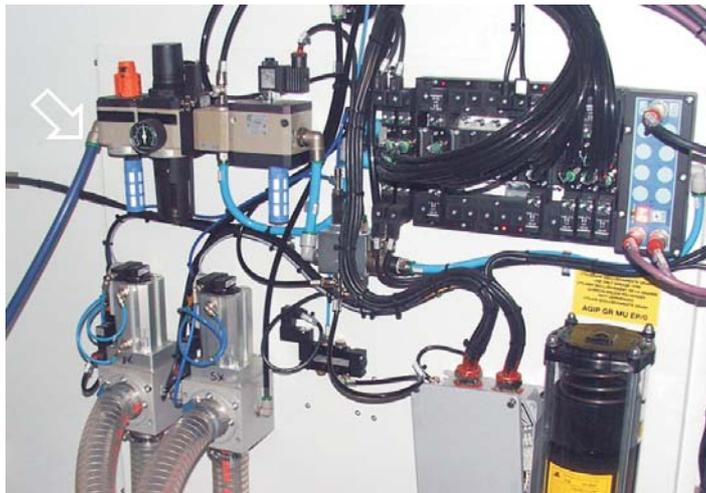
Защитные и отсечные устройства.
