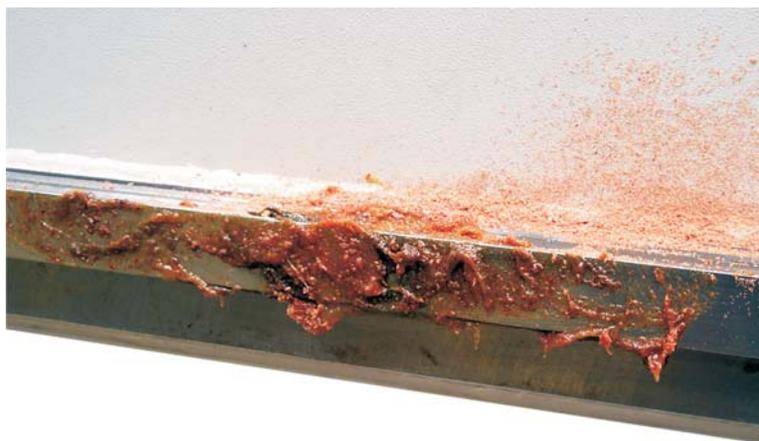
**Внимание** Наличие избыточной смазки на направляющих, винтах с рециркуляцией сфер и зубчатых рейках может привести к падению смазки на обрабатываемые детали и сказаться на качестве.
